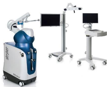
図5.ロボティックアームとナビゲーションシステムが組み合わさったMakoシステム
